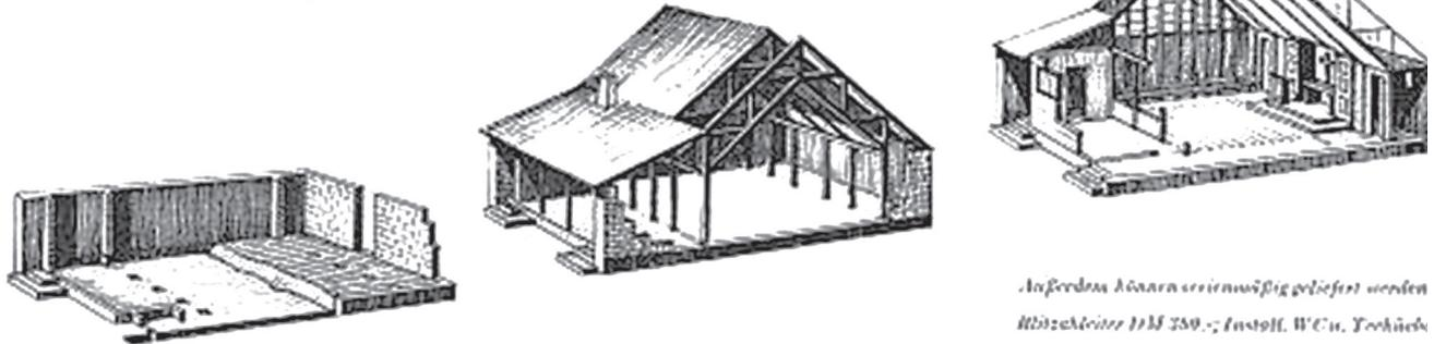
Abb. 55: Isometrische Darstellung des Konstruktionsaufbaus einer Diasporakapelle mit Kostenaufstellung, 1950
