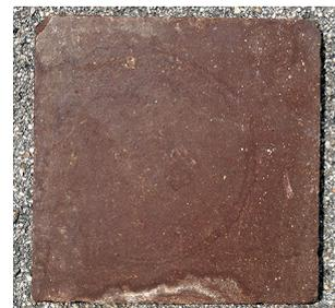
Abb. 83: Holz-Zementfliesen (Abmessungen 25 x 25 x 2 cm)
